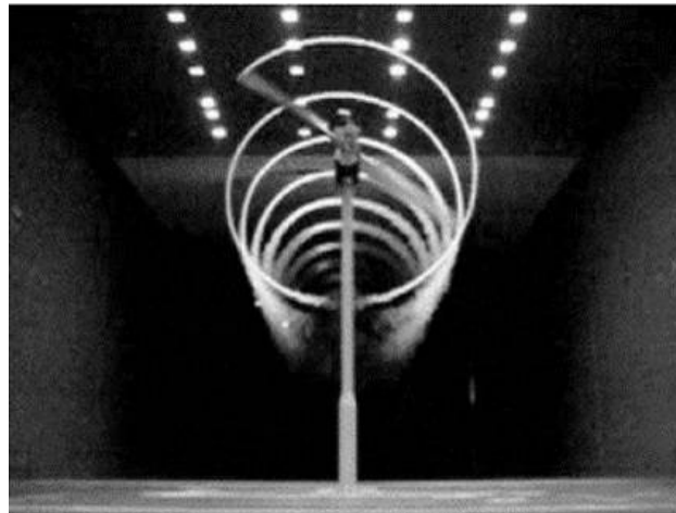
Figura 1.10. Visualización del flujo en la punta del aerogenerador NREL de la NASA-Ames. Fuente: [17].
