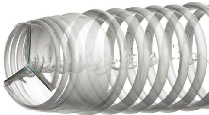
Figura 1.6. Vórtices de salida detrás de un aerogenerador. Fuente: [14].
